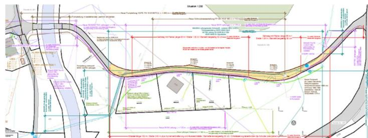
Der Bau der neuen Erschliessung hat begonnen und umfasst einen Gehweg, eine stellenweise Verbreiterung der Strasse, damit der Verkehr kreuzen kann, die Wasserversorgung für die Anwohner und das Löschwasser für den neuen ASTRA-Tunnel, BKW- und Swisscomleitungen, sowie die Schmutzwassererschliessung mit Pumpwerk.
